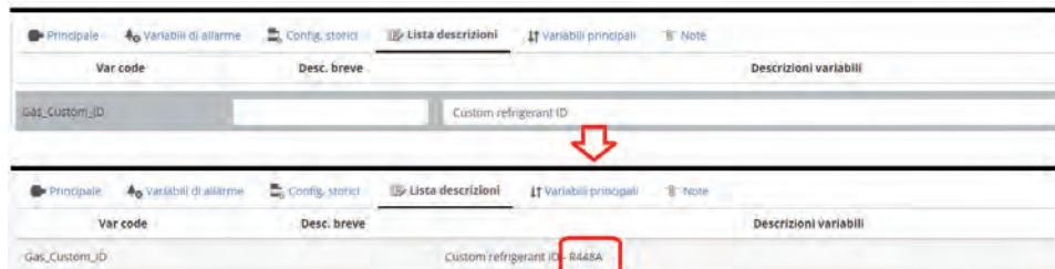
Cuando se hayan configurado los parámetros para el gas personalizado seleccionado, se recomienda actualizar la descripción de la identificación del refrigerante agregando el código correspondiente (por ejemplo, R448A).
